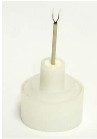
Figura 4.7: Sonda de anemômetro de fio quente, retirada de Eguti (2005)
