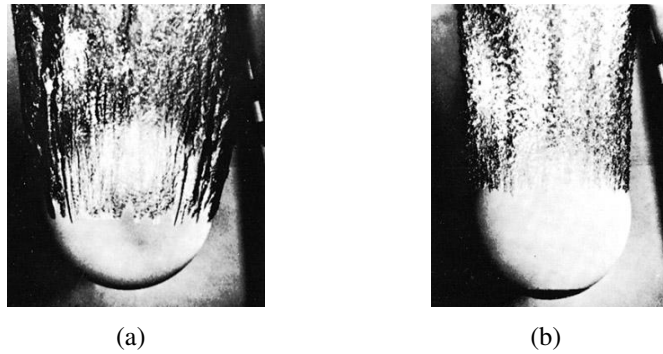
Figura 3.2: Separação da camada limite (a) laminar (b) turbulenta. Retirada de White (1999)
